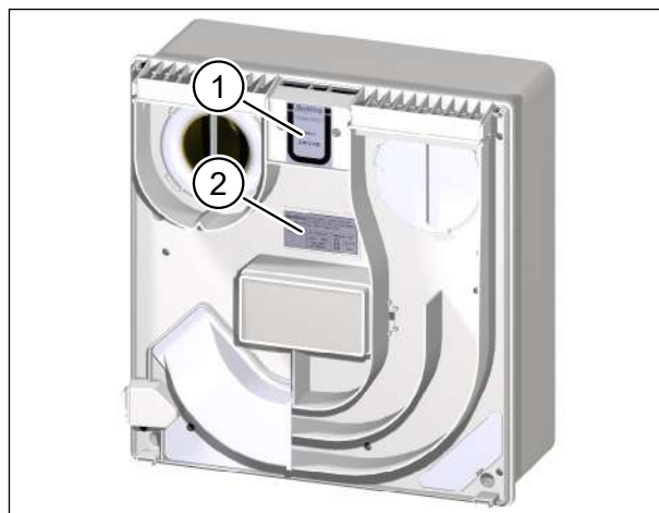
Obr. 3: Umístění čísla schválení a typového štítku
