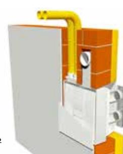
Napojení druhé místnosti může být provedeno podle požadavků flexibilním potrubím nebo plochým kanálem.
